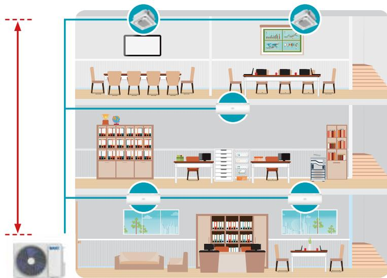
La lunghezza massima delle tubazioni del circuito frigorifero può arrivare ad un massimo di 65 metri (nei modelli Mono Split) o 80 metri (nei modelli Multi Split), di sola andata. Inoltre, la differenza di altezza massima tra unità esterna e la/e unità interna/e è di 30 metri (nei modelli Mono Split) e di 15 metri (nei modelli Multi Split). Questo assicura un'installazione semplice, flessibile ed economica.
